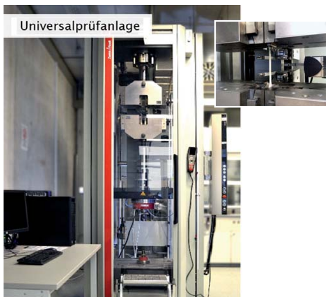
Abb. 2: Universalprüfanlage Zwick Z250 Allround-Line (links) und die damit ermittelten Spannungs-Dehnungs-Kurven von 3D-gedruckten Kunststoffprobekörpern mit und ohne Faserverstärkung unter Zugbelastung (rechts).
