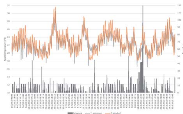
Abb. 2: Temperaturverlauf im Sommer für Messung und Simulation in Halle Erdgeschoss. © Sandra Schmid, Felix Wellnitz, OTH Regensburg, 2018
