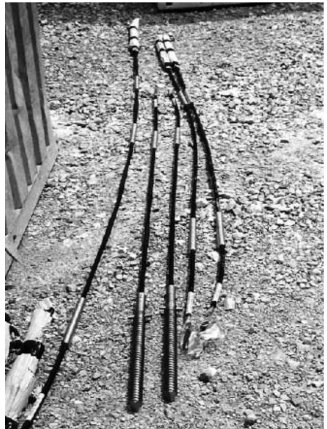
Bild 2: Auf dem Versuchsfeld Schrobhausen eingesetzte Messtechnik: Integralgeber als Messkette. Der Messbereich eines Gebers liegt zwischen den Messingringen bzw. der Spitze und den Messingringen. Vorne schraubenförmige Verankerungsspitze zur Fixierung am Verpresskopf.
