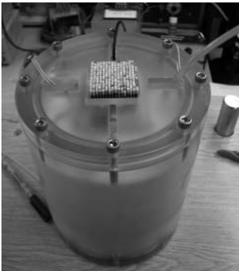
Abbildung 2: Taktiler Array mit 16*16 Elementen
