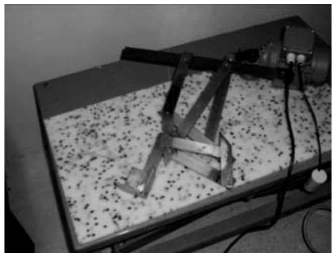
Bild 12: Komponenten des Gelenkmechanismus mit Antrieb ohne Übergabestation
