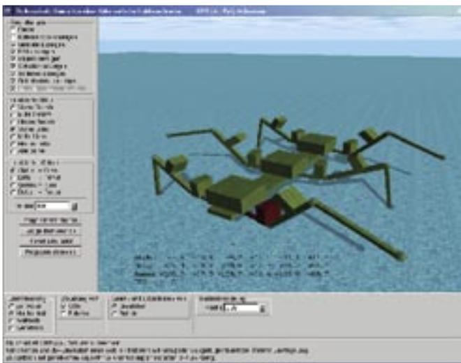
**Abbildung 9:** Benutzeroberfläche für Simulation und Steuerung des angeschlossenen Roboters
