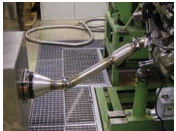
▼ Abbildung 7: Anschluss der Abgasanlage an die Katalysatorscheibe und den Beruhigungstunnel
