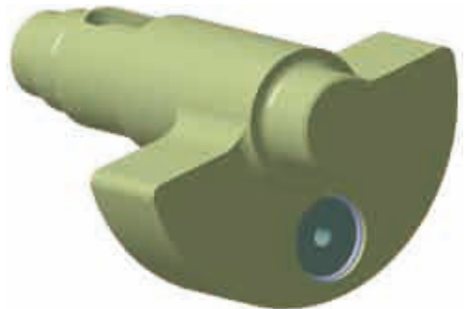
Bild 5: Ausgleichswelle 1. Ordnung mit „Austauschmassen“
