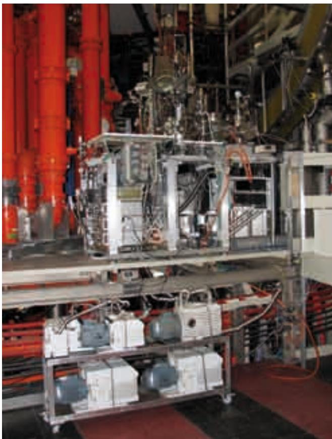
Bild 8: Leidenfrost-Kanone und zugehöriges Pumpsystem installiert an ASDEX Upgrade.
