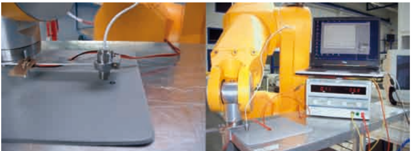
Abbildung 2: Erste Realisierung der Wegmessung (links), Teststand für erste Messungen (rechts)
