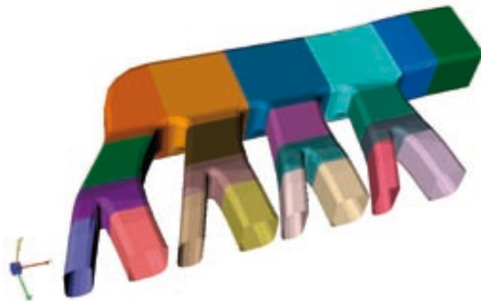
Abbildung 19: CAD-Modell der Ansaugbrücke
