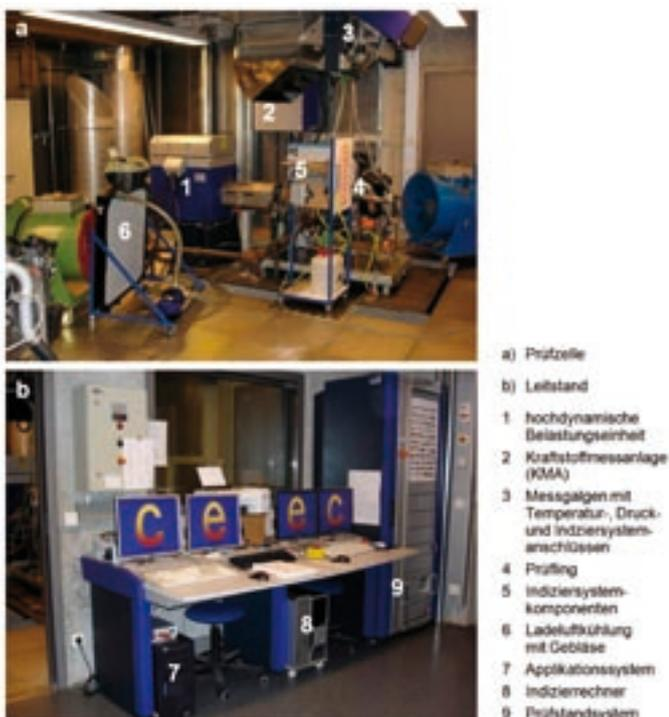
Abbildung 9: Motorprüfstand mit Prüfzelle und Leitstand
