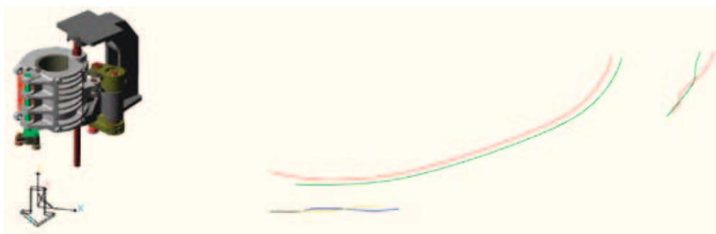
**Bild 9:** Detailliertes Modell mit Verschlussmechanismus und Dämpfer
