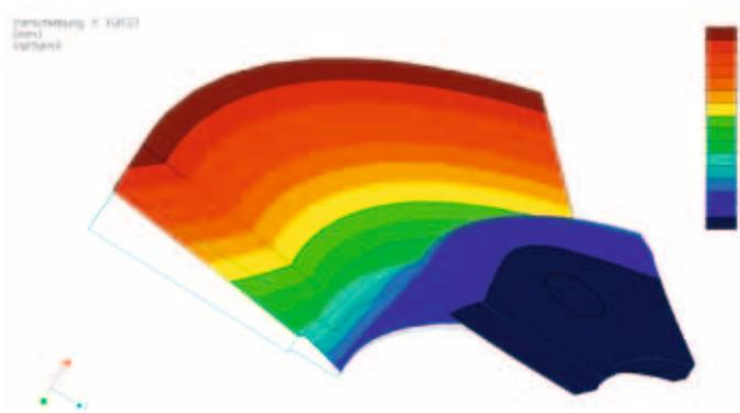
Abb. 6: Verformung der Bremsscheibe in axialer Richtung
