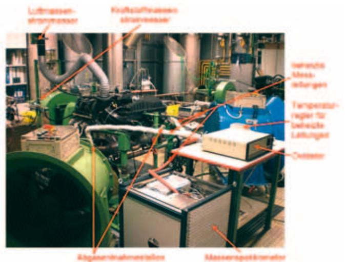
Abb. 6: Messaufbau für SO<sub>2</sub>-Tracer-Methode
