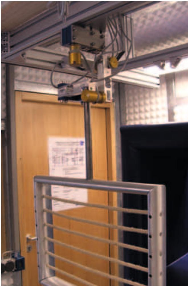
**Abb. 1:** Versuchsaufbau in der offenen Messstrecke im Regensburg Wind Tunnel (RWTT), Hochschule Regensburg, Seilrahmen (unten) mit Kraftmess-einrichtung (oben).
