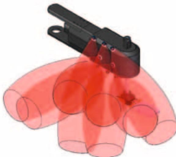
**Abb. 3:** Ansicht der für die Interaktion mit dem Menschen kritischen Roboterbauteile mit Ultraschallsensoren auf einer Seite
