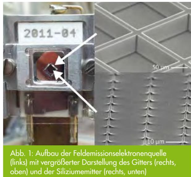
Abb. 1: Aufbau der Feldemissionselektronenquelle (links) mit vergrößerter Darstellung des Gitters (rechts, oben) und der Siliziumemitter (rechts, unten)
