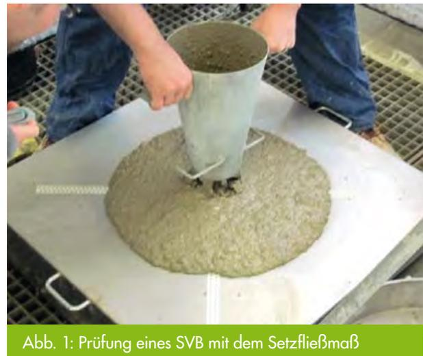
Abb. 1: Prüfung eines SVB mit dem Setzfließmaß
