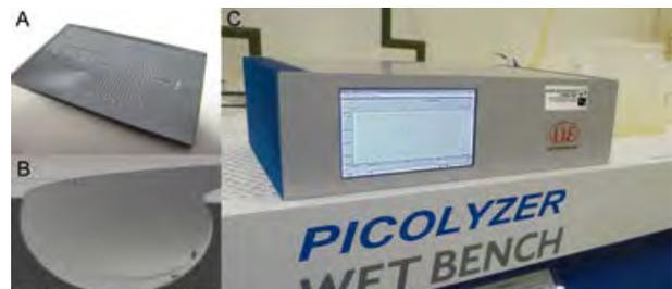
Abb. 1: (A) REM-Aufnahme des Kanalquerschnitts des spiralförmigen Kanals, (B) Mit Glas gedeckelter Mikromischer, (C) Picolyzer-Prototypen mit allen integrierten Bauteilen
