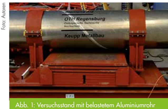
Abb. 1: Versuchsstand mit belastetem Aluminiumrohr
