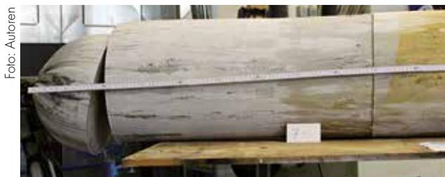
Abb. 2: Tragelement zur Herstellung von Proben für Elementversuche
