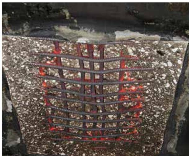
Abb. 2: Stahlbetonversuchsplatte nach Brandversuch mit tiefen Betonabplatzungen
