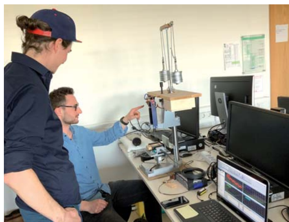
Für das HaptiVisT System wird ein Versuchsaufbau entwickelt, um den notwendigen Druck bei der Bohrung am Beispiel von Hühnerknochen zu messen.
