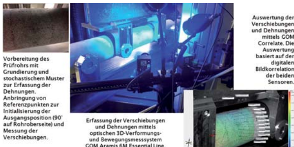
Abbildung 3: GOM-Messungen mit Vorbereitung des Prüfkörpers, Orientierung in Prüfkammer sowie Auswertung in Software GOM Correlate.
