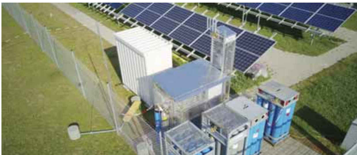
Der für das Forschungsprojekt „ORBIT“ an der OTH Regensburg entwickelte Bioreaktor wird um einen Elektrolyseur erweitert und in eine skalierbare Containerlösung umgebaut. Foto: OTH Regensburg/Michael Heberl
